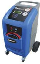
Станция для утилизации, очистки и заправки фреона. База данных содержит нормы заправки фреона и масла 1000 моделей автомобилей. Автоматическая утилизация-очистка. Автоматическая заправка фреоном. Насос 75 л/мин. Скорость утилизации 300 гр/мин. в жидкой фазе. Сигнализация о высоком давлении, полном/пустом баллоне, замене фильтра. Вес 80 кг.
