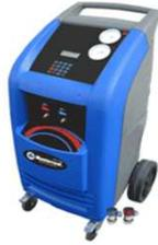
Станция для утилизации, очистки и заправки фреона. База данных содержит нормы заправок фреона и масла 1000 моделей автомобилей. Автоматическая утилизация-очистка. Автоматическая заправка фреоном. Насос 75 л/мин. Скорость утилизации 300 гр/мин. в жидкой фазе. Сигнализация о высоком давлении, полном/пустом баллоне, замене фильтра. Вес 80 кг. | 5228,00 \$ |
