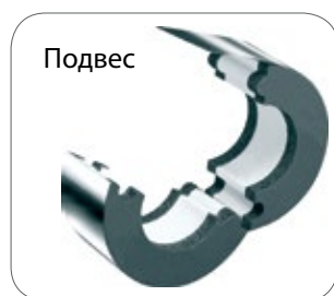
Комбинированное изделие из двух пенополиуретановых полуколец (к торцам приклеены полукольца из теплоизоляционного материала надлежащей марки, с наружным бандажом из ПВХ, имеющим самоклеящийся нахлест по продольному шву)
